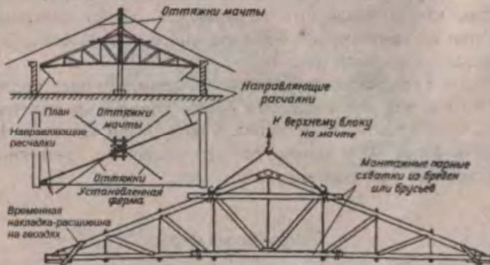
Рис. 25. Подъем треугольной фермы на лобовых врубках при помощи мачты на оттяжках
