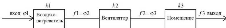
Рис. 1. Система «воздухонагреватель – вентилятор – помещение»: \phi_1 – входной сигнал системы, представляющий собой единичный скачок; f_1 ( \phi_2 ) – выходной сигнал воздухонагревателя, также являющийся входным сигналом вентилятора; f_2 ( \phi_3 ) – выходной сигнал вентилятора, также являющийся входным сигналом помещения (сильно зашумлен); f_3 – выходной сигнал системы
