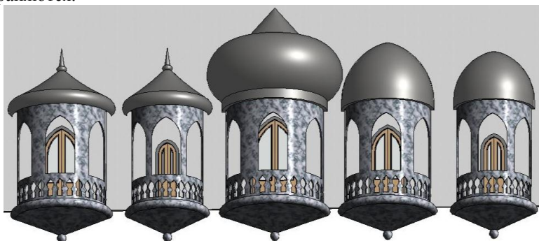
Рисунок 4 – Эркеры созданные на основе одного семейства
