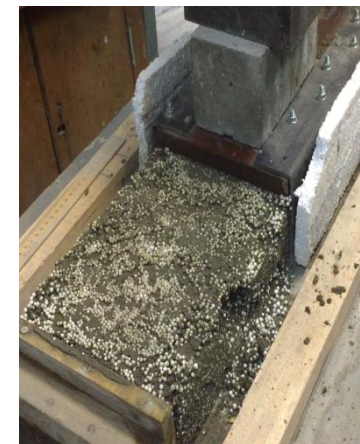
Экспериментальная установка для экструдирования полистиролбетонной смеси
