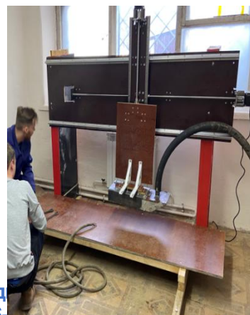
Экспериментальная установка для экструдирования полистиролбетонной смеси
