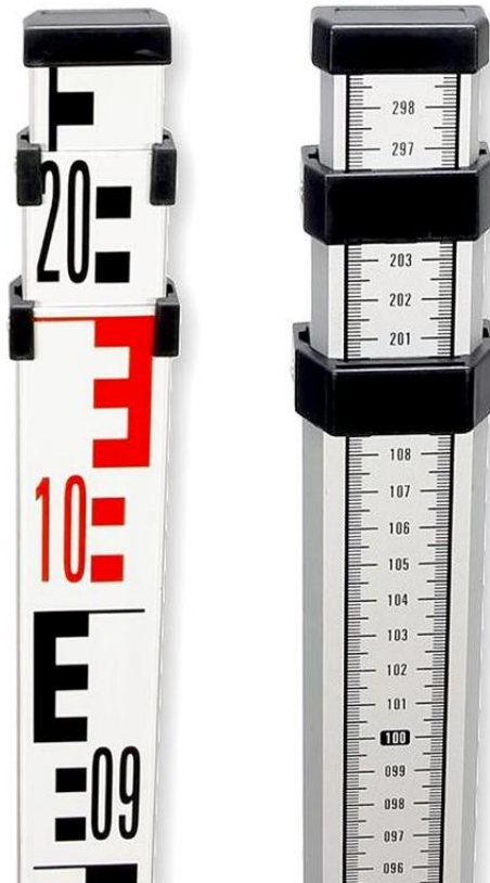
Рис. 9. Телескопические нивелирные рейки
