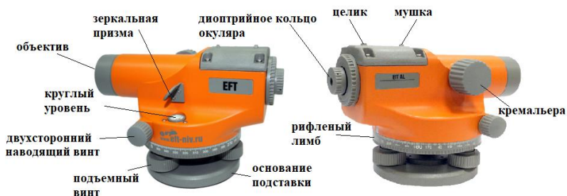
Рис. 2. Устройство нивелира EFT AL-32
